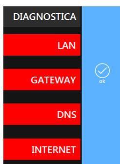
Figura 72: Diagnostica -> Sistema non collegato alla rete LAN
